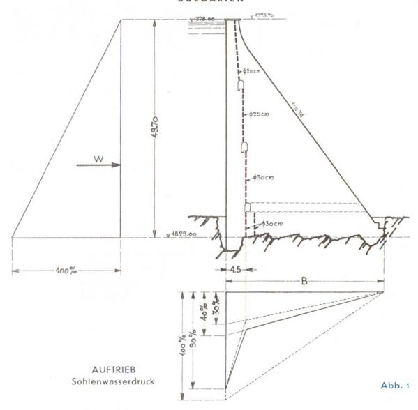
dagegen das Bauwerk eine Kombination von horizontaler Gewölbewirkung und vertikaler Konsolwirkung entsprechend der Einspannung des Mauerwerkkörpers in den Talflanken und der Talsohle. Die Berechnung dieser Gewölbesperren beruht auf der Annahme, dass sich die Mauer in jedem beliebigen Punkte infolge Gewölbewirkung und Konsolwirkung in gleicher Weise deformieren wird.
