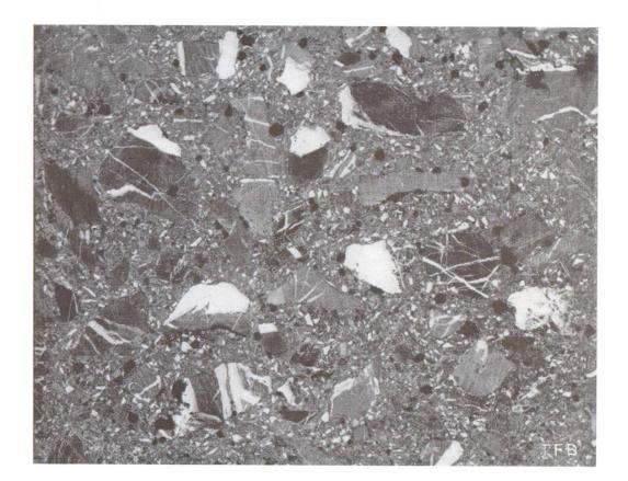
Abb. 6 Geschliffener und hochglanzpolierter Beton
