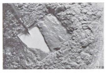
Die Mischung enthält zuviel Sand und und Wasser. Obwohl sehr leicht verarbeitbar, können mit solchem Beton keine hohen Festigkeiten und Undurchlässigkeit erzielt werden
