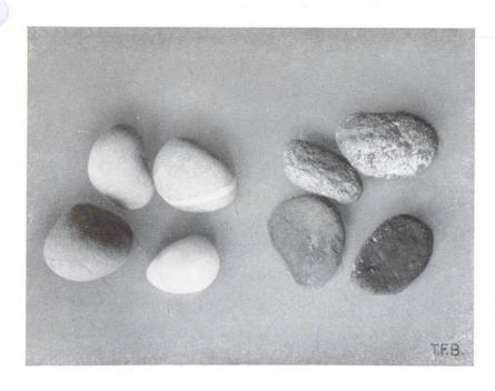
Abb. 2 Links gesundes, rechts verschmutztes oder verwittertes Steinmaterial
