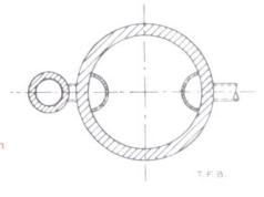
Abb. 5 Fettabscheider aus Beton mit befahrbarem Betondeckel
