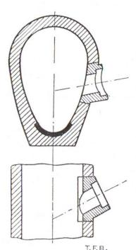
Abb. 2 Eiform-Kanalisationsrohr mit Steinzeugsohle und Anschlussmuffe
