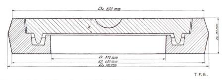
Abb. 3 Betondeckel mit Geruchverschluss (Pat. ang.)
