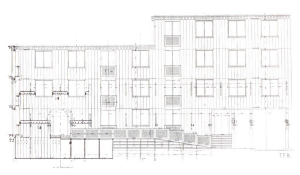
Wohnsiedlung in Drancy bei Paris. Architekten E. Beaudouin und M. Lods, Paris. Standardisierte Serienelemente in Eisenbeton für Aussenwände, Decken, Balkone, Brüstungen, Fensterrahmen
