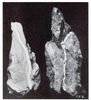
Abb. 5 Material probe aus cementierter Felskluft (Hochdruckinjektion) R. Grün, Der Beton, 2. Auflage, S. 209
