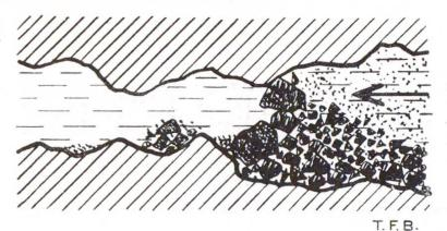
Schematische Darstellung des Ausfilterns einer Aufschlämmung in einer Pore (Längsschnitt, stark vergrös-
