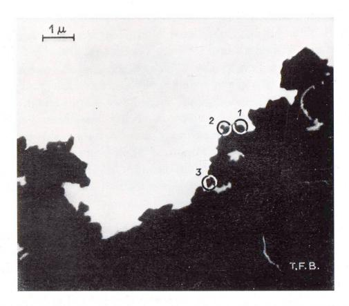
Abb. 7 Wiedergabe einer Aufnahme von Cementmehl mit dem Elektronen-Mikroskop. Vergrösserung 10 000-fach. An den Randpartien sind die feinsten Einzelteilchen (umrahmt) zu unterscheiden (aus Haegermann, Zement 1942, Seite 442)
