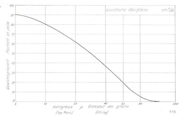
Abb. 6 Kornverteilungskurve eines Cements. Korngrössen in 1/1000 Millimetern
