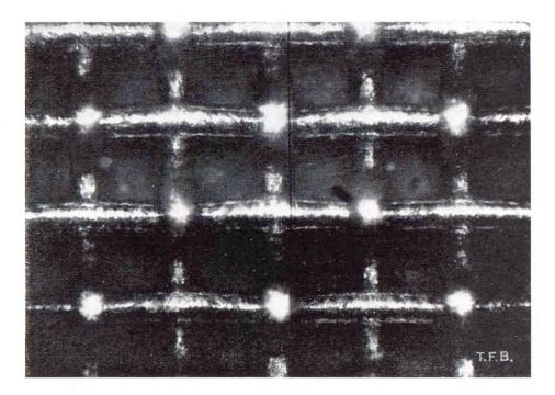
Abb. 3 Prüfsieb mit 4900 Maschen per cm² in 125-facher Vergrösserung
