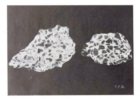
Abb. 1 Römischer Beton, ausgegraben in Kaiseraugst (Augusta raurica)
