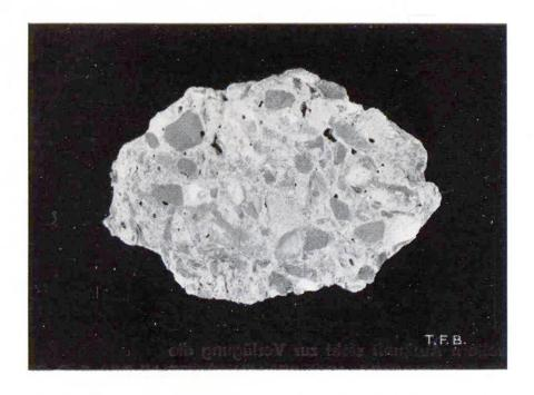
Abb. 2 Römischer Beton aus Wasserleitung in Avenches (Aventicum)
