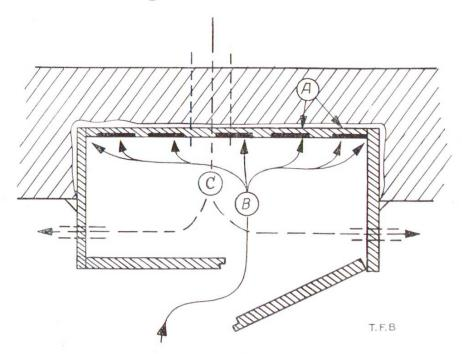
Abb. 2 Feuchtigkeitsanreicherung (A) an der Rückwand eines Kücheneinbaus. Die von der Küche eindringende gesättigte Warmluft (B) schlägt an der kühlen Rückwand Schwitzwasser nieder. Durch natürliche Luftzirkulation im Sinn von (C) werden Verschimmelungen und Schwitzwasser vermieden
