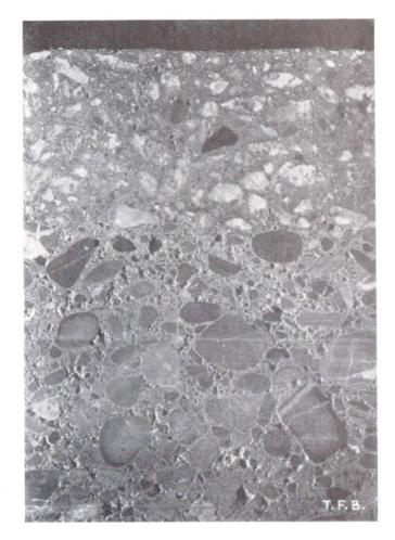
Abb. 5 Probe aus Strassenbelag. Die Verschleisschicht enthält zur Verminderung der Abnützung Granitsplitt.
