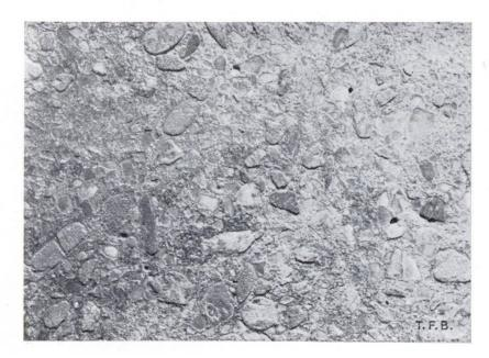
Abb. 2 Belagsoberfläche nach längerem Gebrauch (Reliefbeleuchtung)
