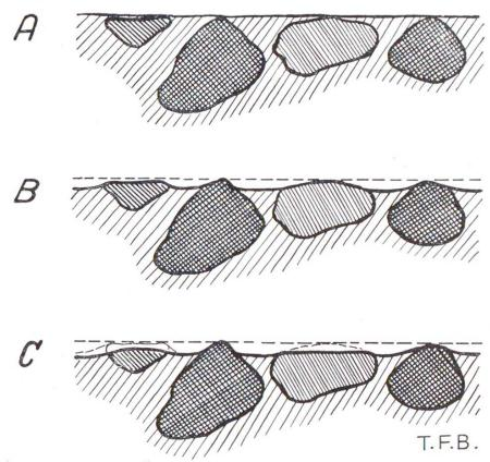
Abb. 3 Schematische Darstellung der sukzessiven Abnützung von Beton.
