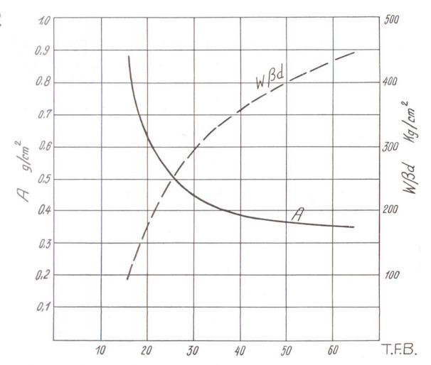
Abb. 1 A = Abnützung in g/cm², w  $\beta$  d = Betondruckfestigkeit. Abnützungsversuche an Betonmischungen verschiedener Festigkeit. Bei gleichem Zuschlagsmaterial ist die Abnützung umso geringer, je höher im allgemeinen die Druckfestigkeit ist.
