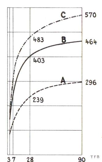
Abb. 3 Darstellung der Druckfestigkeiten von Beton, hergestellt mit den Sandkiesen A, B und C, bis zum Alter von 90 Tagen
