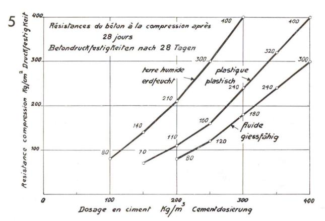
Abb. 4 Einfluss der Cementdosierung und der Konsistenz auf die Betondruckfestigkeiten
