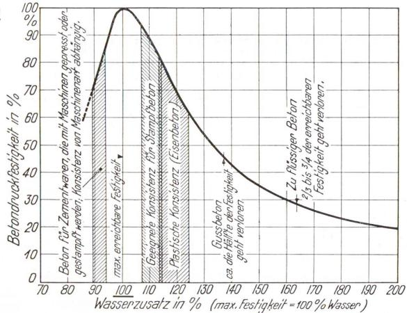
Abb. 1 Einfluss der Anmachwassermenge auf die Betondruckfestigkeiten
