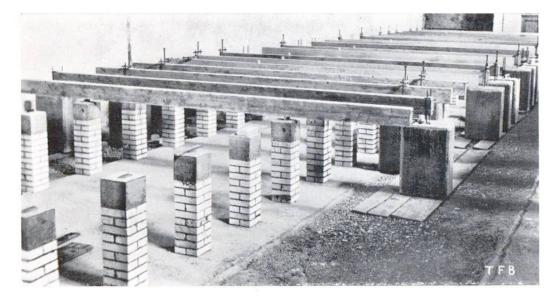
Abb. 4 Probebalken aus vorgespanntem Eisenbeton. Versuchsanlage in Schinznach-Bad der SIA-Kommission für vorgespannten Eisenbeton
