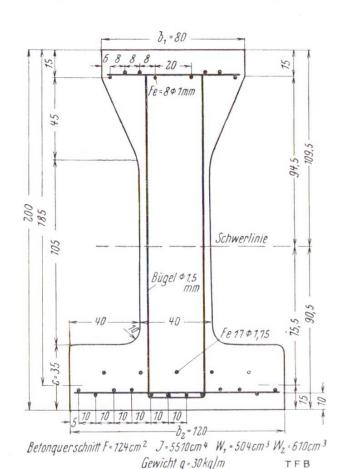
Abb. 2 Querschnitt eines Hoyer-Stahlsaitenbalkens. (Aus Hoyer: "Der Stahlsaitenbeton", erster Band)
