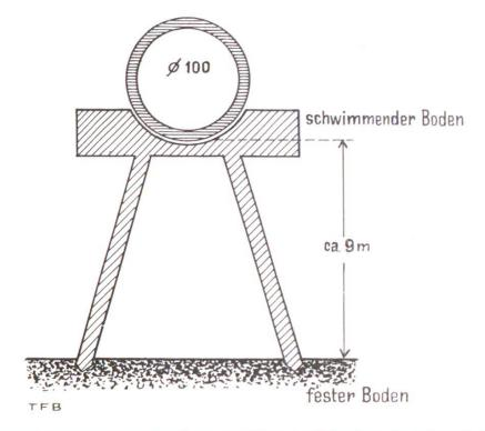
Abb. 8 Beispiel: Superbetonrohrleitung Ø 100 cm in Effretikon. Projekt und Bauleitung: Techn. Bureau E. Meier, Wetzikon
