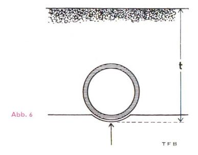
Minimale Verlegetiefen der Rohre bei einem Raddruck von 6 Tonnen.
