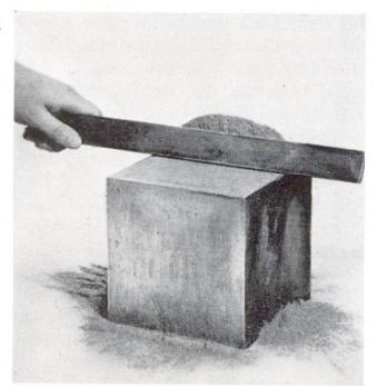
Fig. 1 Bestimmung des Raumgewichts von Cementen. Der Cement wird lose in das kalibrierte Gefäss von 4 Liter Inhalt einlaufen gelassen und mit einem Lineal abgestrichen. Hierauf wird der Inhalt gewogen.
