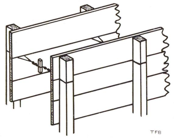
Fig. 1 Innere und äussere Schalungswand sind durch verdrillte Drähte miteinander verbunden. Diese Drähte nehmen den Seitendruck des frischen Betons auf. Bei grossen Drücken werden die Drähte durch papierummantelte Gewindestangen ersetzt.
