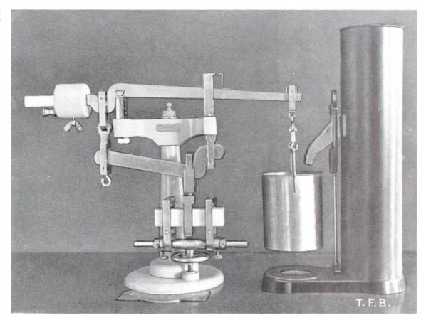
Fig. 3 Biegeversuch an Mörtelprisma 4 x 4 x 16 cm.
