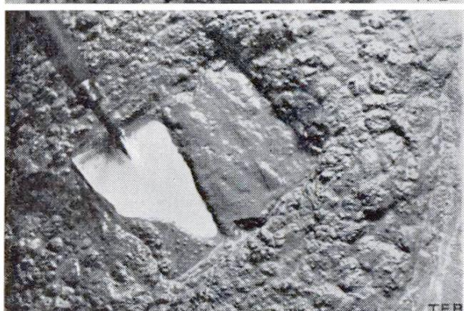
Die Mischung enthält zuviel Sand und Wasser. Obwohl sehr leicht verarbeitbar, können mit solchem Beton keine hohen Festigkeiten und Undurchlässigkeit erzielt werden.
