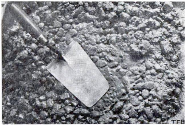
Diese Betonmischung enthält zuviel Kies und ist trotz grossem Wassersatz schlecht verarbeitbar. Solcher Beton gibt Anlass zu Nesterbildung.
