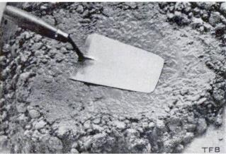
Dieser Beton ist richtig! Alle Bestandteile sind in den günstigsten Verhältnissen vorhanden und die Konsistenz ist so, dass der Beton erst beim Verdichten plastisch (teigförmig) wird. Beim Streichen mit der Kelle bildet sich eine geschlossene Oberfläche.
