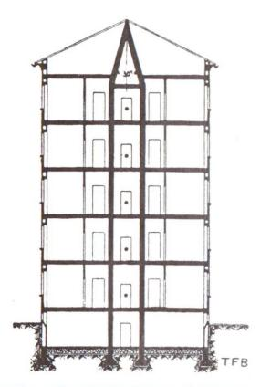
Fig. 3 Eisenbeton-Skelettbau mit volltreffersicherem Schutzraum auf allen Stockwerken.
