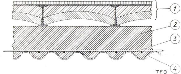
Fig. 5 Verstärkung einer bestehenden Hourdisdecke.
