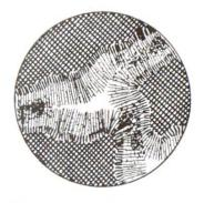
Erhärtender Cement: Die Gelhüllen wachsen zusammen. Beginn der Versinterung durch Kalk.
