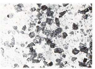
Fig. 2. Cementmehl bei mehrhundertfacher Vergrösserung unter dem Mikroskop. Die durchschnittliche Korngrösse beträgt etwa 1/50 Millimeter.
