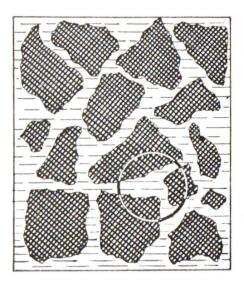
Struktur des frischen Cementteigs. Das Wasser wirkt als Schmiermittel und die einzelnen Cementkörnchen sind mit einem Wasserfilm umgeben. Raumgewicht des Cementteigs 2,1 Kilo/Liter.
