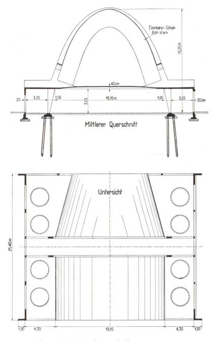
Abb. 1. Untersicht und Querschnitt der Cementhalle
