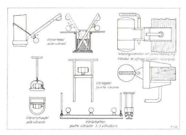
Abb. 4 **Verschiedene Geräte für die Aussenvibration** — Schalungsvibrator, Vibrierhebel, Vibriergabel — **und die Oberflächenvibration** — Vibrierschaufel, Vibrierbalken.
