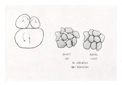
Abb. 1 Wirkung der Vibration.
