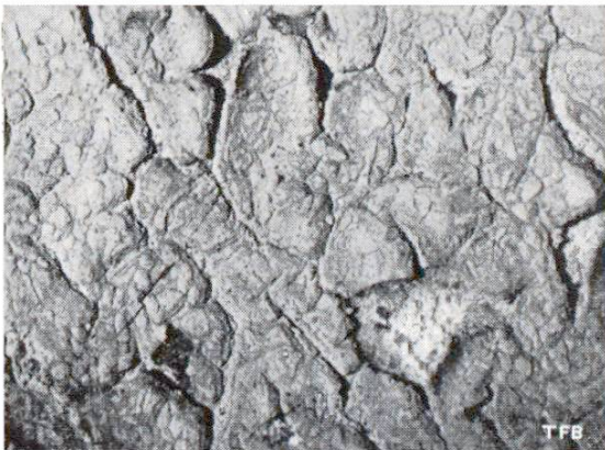
Abb. 1 Zersetzung eines Oelfarbanstriches auf alkalischer Betonunterlage. - Geeignete Vorbehandlung des Betons wurde unterlassen.
