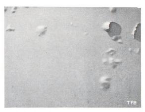
Abb. 2 Aufblähungen auf einem Oelanstrich — Cementputzunterlage.
