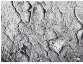
Abb. 1 Zersetzung eines Oelfarbanstriches auf alkalischer Betonunterlage. - Geeignete Vorbehandlung des Betons wurde unterlassen.
