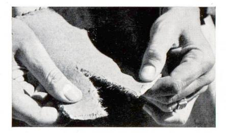
Abb.2 Zerreissen einer frischen (unabgebundenen) Eternitplatte. Die Asbestfaser-Armatur ist deutlich ersichtlich.
