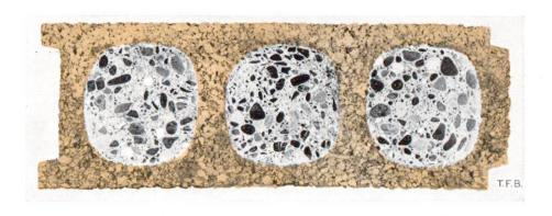
Abb. 1 Querschniff einer Wand aus Baukork (Beton und Kork) Wärmedurchgangszähl k = 0,65
