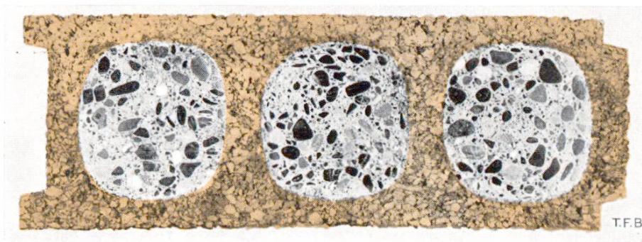
Abb. 1 Querschnitt einer Wand aus Baukork (Beton und Kork) Wärmedurchgangszahl k = 0,65
