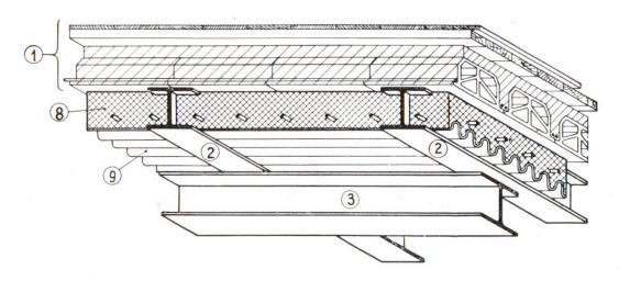
1 bestehende Decke 2 Träger 3 Unterzüge 8 Eisenbeton 9 Wellblech
