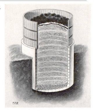
Abb. 2 Runder Grünfuttersilo aus Eisenbeton mit aufgesetztem Holzkranz.
