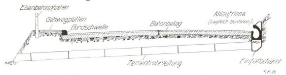
Abb. 1 Betonstrasse, ausgerüstet mit modernen Cementwaren
