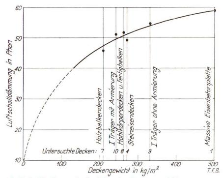
Abb. 1 Luftschallisolierung in Funktion des Deckengewichtes
