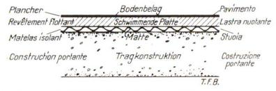
Abb. 2 Trittschallisolierung einer Decke durch Einbau eines schwimmenden Belages auf Isoliermatten
