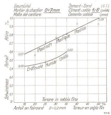
Abb. 2 Schwindmasse von Baumörteln 1:6 (G.T.) in Funktion des Feingehaltes und der Konsistenz (nach Graf, Stuttgart).
