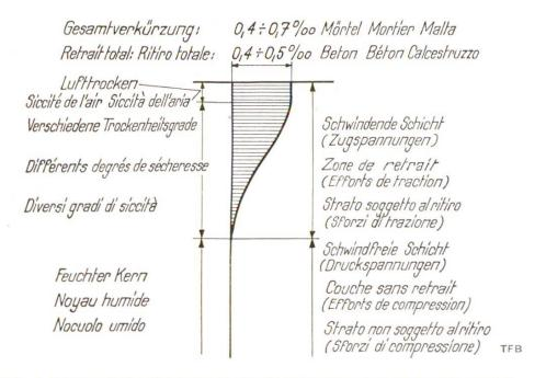
Abb. 1 Schematische Darstellung des Schwindens eines Betonelementes während der Austrocknung an der Luft.
