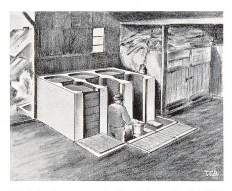
Abb. 2 Anordnung eines sechszelligen, halbversenkten Kartoffelsilos aus Stampfbeton
