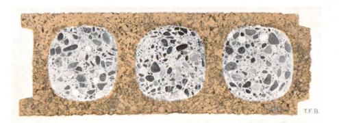
grossen Hohlräume der an den Stirnseiten gekehlten Korksteine werden mit Beton angefüllt.
