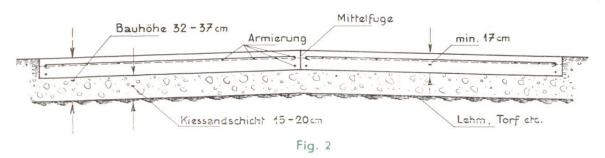
Diese Vereinfachung des Unterbaues im Betonstrassenbau wirkt sich bei Strassenneuanlagen derart günstig aus, dass dort Betonbeläge meist niedriger zu stehen kommen als billigere Belagsarten. Infolge der geringeren Bauhöhe kann im Einschnitt zudem an Aushub gespart werden.
