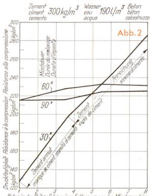
Beton in der Reitrenfolge seiner Entleerung aus der Mischmaschine Prélévements successifs du béton lors de la vidange du malaxeur Prelevamento successivo del calcestruzzo durante lo svuotamento dell'impastatrice
