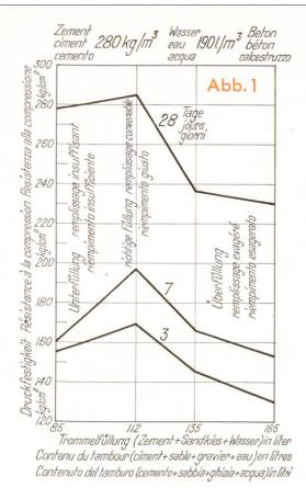
Abb. 2. Einfluss der Mischdauer auf die Betondruckfestigkeit. Zum Versuch diente eine von einer beliebigen Baustelle genommene Mischmaschine mit schräggelagerter Trommel, ein sog. Wälzmischer. Der Beton wurde in der Reihenfolge, wie er aus der Mischmaschine kam, zu Probekörpern (unten auf der Horizontalen als Nr. 1, 2, 3
