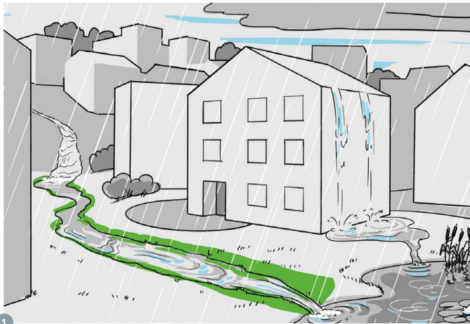
Figure 1: L'écoulement de l'eau de pluie et du ruissellement de surface doit être planifié suffisamment tôt et dans une perspective globale, en prenant en compte l'éventualité d'une surcharge. Illustration: www.protection-dangers-naturels.ch
