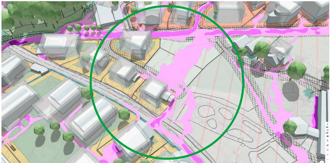
Figure 4: La superposition de la carte des aléas dans le jumeau numérique fait ressortir le potentiel de dangers.
