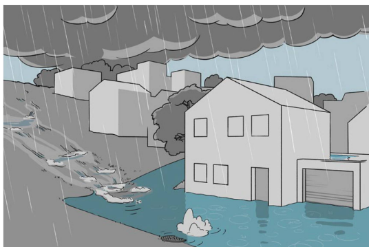
Figure 1: Des pluies intenses localisées déversent en quelques minutes des quantités d'eau qui dépassent les capacités des installations d'évacuation. Deux bâtiments sur trois en Suisse sont potentiellement menacés par le ruissellement de surface.
