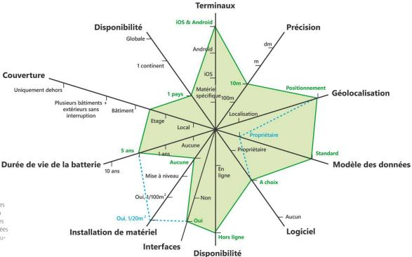
Figure 1: diagramme en étoile des exigences de swisstopo dans le projet pilote. Les exigences sont présentées en vert, les écarts découlant de considérations pratiques sont en bleu.
