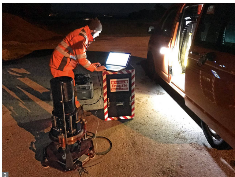
Figure 1: lien entre le géoïde et les déviations de la verticale Figure 2: la caméra zénithale «CODIAC» et ses différents éléments constitutifs Figure 3: la caméra «CODIAC» en station sur un point
