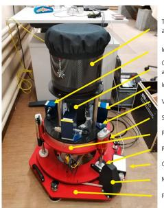
Télescope/objectif avec protection anti-condensation télescopique
