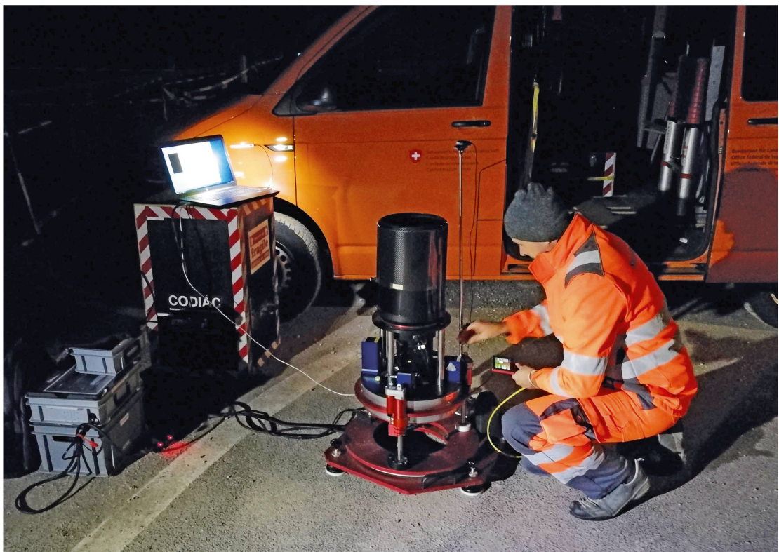
Figure: Mesure de la déviation de la verticale avec la caméra zénithale numérique CODIAC
