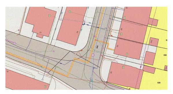
Figure 2: exemple de représentation dans un cadastre des conduites
