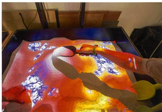
Réalité augmentée: si le bac ne contient que du sable, l'outil informatique gérant les modifications du terrain et la projection sur la surface donnent un tout autre relief aux informations.
