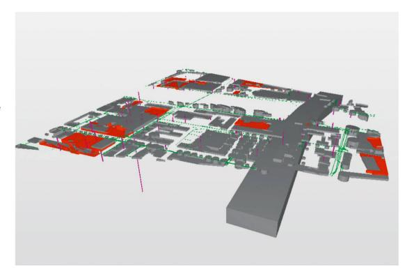
Figure 3: classification sémantiquement correcte d'objets souterrains dans Solibri
