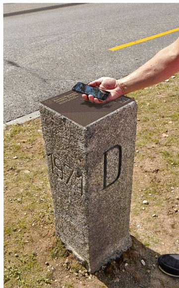
Figure 2 (à gauche): deux en un, à la fois point de contrôle pour équipements de navigation mobiles et point fixe planimétrique 2 de la mensuration officielle
