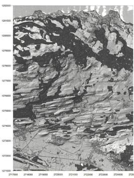
Figure 5: exemple d'estompage du relief (MNS), nuages de points et profils en travers à l'aide des données LiDAR issues de l'UR 2017/2018
