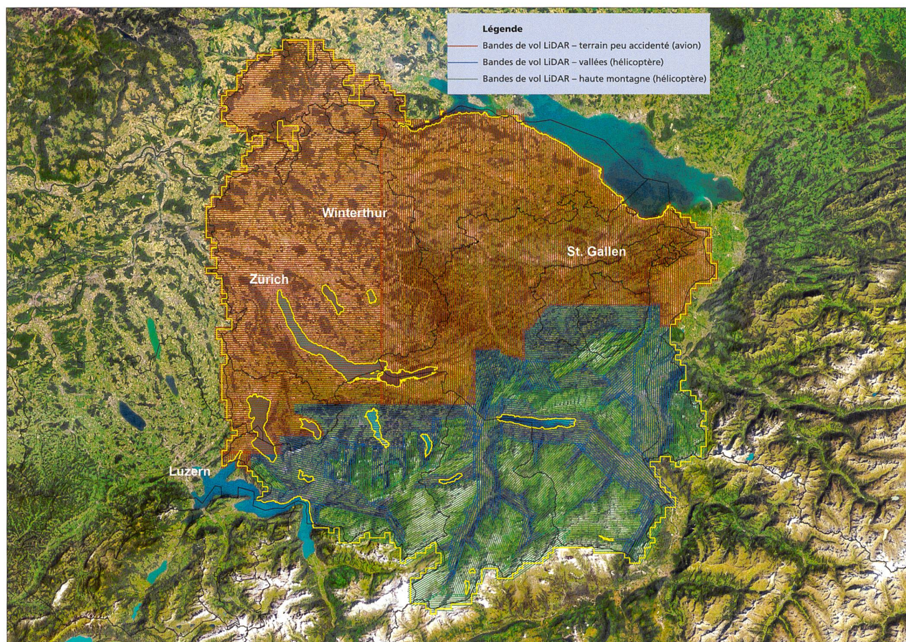
Figure 3: UR 2017/2018 – périmètres et lignes de vol LiDAR
