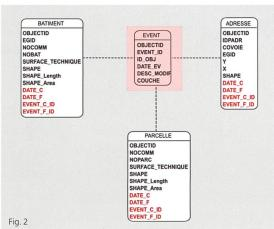
On obtient alors une modélisation simplifiée de la base de données, représentée sur le schéma ci-dessus (fig. 2). La base se remplit au fur et à mesure des mises à jour, des modifications, des créations et des suppressions d'objets. Chaque couche de la base temporelle est alors constituée par la superposition de tous les objets radiés ou encore en vie. Cette superposition rend impossible la validation des règles topologiques usuelles dans la base temporelle.
