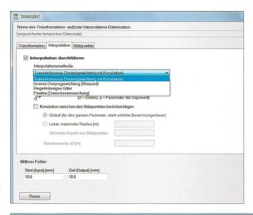
Figure 3: les diverses possibilités d'interpolation (TRANSINT, Shepard, grille et FINELTRA) dans le module TRANSINT, avec les paramètres qui leur sont associés
