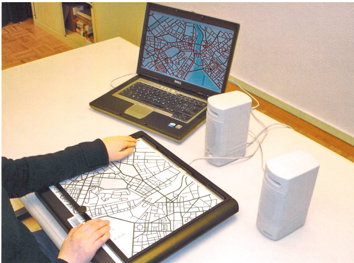
Fig. 1: les éléments du dispositif ABAPlans: un ordinateur, une tablette tactile, un plan en relief et des haut-parleurs
