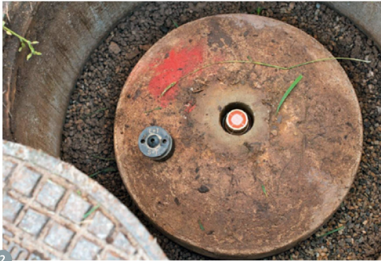
Abbildung 2: Typischer Lagefixpunkt im Flachland. Die Kappe (links) ist abgeschraubt und eine Zentrierscheibe ist im Kappenbolzen eingesetzt. Falls möglich wurden die Punkte im Gegensatz zu hier nicht in ein Betonfundament, sondern direkt im Fels eingelassen.
