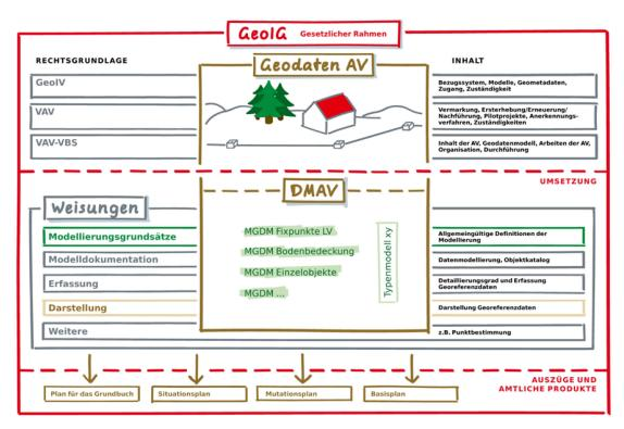
z.B. «Fixpunkte Landesvermessung» oder «Bodenbedeckung». Diese minimalen Geodatenmodelle werden unterstützt durch sogenannte Typenmodelle, welche allgemein gültige und wiederkehrende Definitionen beinhalten (beispielsweise Qualitätsstandards, Informationen zu Textpositionen). Alle Modelle können unabhängig voneinander weiterentwickelt werden. Damit ist das DMAV sehr agil, bietet aber gleichzeitig auch die Möglichkeit, stabil zu sein.
