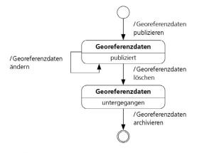
Abbildung 8: Zustandsdiagramm des Geschäftsobjekts «Georeferenzdaten»
