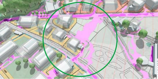
Abb. 5: Strassen sind oft bevorzugte Fliesswege, wie dieses Beispiel der Gemeinde Horw zeigt. Die 3D-Ansicht nilft, eine erste Plausibilisierung der Gefährdungskarte vorzunehmen und mögliche Lösungen zu antizipieren.
