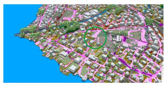
Abb. 4: Die Überlagerung der Gefährdungskarte im digitalen Zwilling macht das Gefahrenpotential sichtbar.
