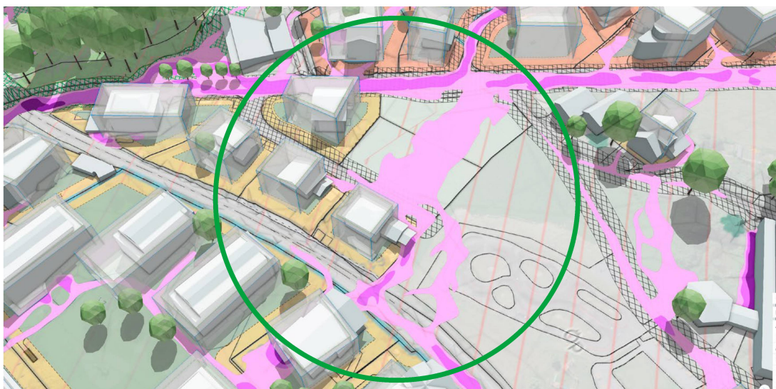
Abb. 4: Die Überlagerung der Gefährdungskarte im digitalen Zwilling macht das Gefahrenpotential sichtbar.
